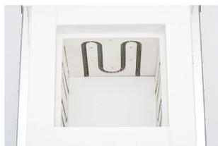
☆炉内に30mm出る熱電対(写真内右上)ヒーター線はφ2.3m/カンタルA1を使用。ポビン式(らせん状)の炉壁嵌め込み型。各面U字ピン30本で固定しているため炉内へのはみ出しがありません。
