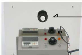
☆φ30mm排気孔を設置。吸気孔よりガスを注入すると、排気孔の開閉(写真は栓で閉めた状況)により炉内雰囲気操作が可能です。
