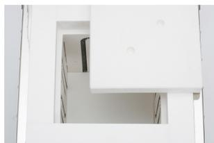
☆蓋が大きく、高温でも開閉が容易です。蓋の開閉時に温度が下がりにくく、金属の焼き入れ焼き房し等、熱処理の利便性が高いです。
